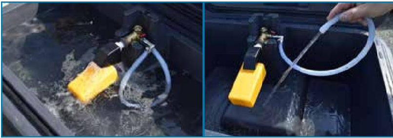
Plūdinis vožtuvas su apsauginiu korpusu nuo porsų. Plovimo sistema.
